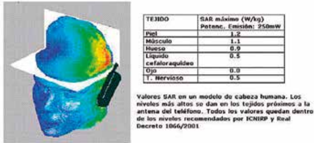
Imagen 5: Valores de SAR en un SAM en laboratorio (Fuente: Ipi.Tel.Uva.es)
