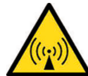
Imagen 16: Emisiones radioeléctricas. Señal de peligro por emisiones radioeléctricas
